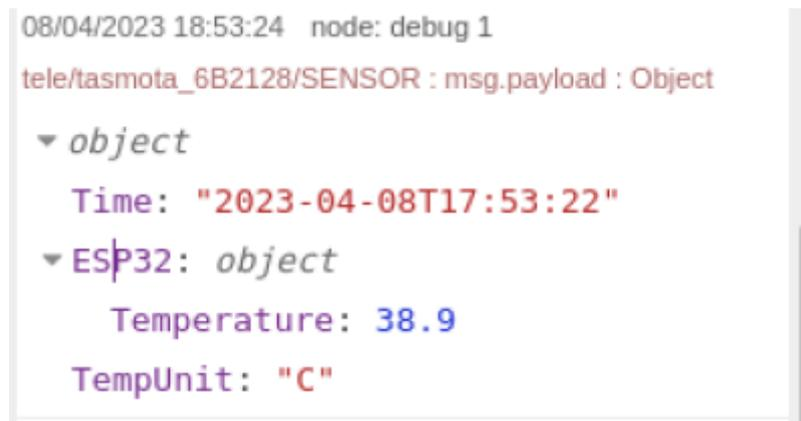
On a bien la temperature qui arrive sur node-red , maintenant il faut l'afficher sur une gauge dans un dashboard
