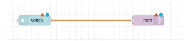
• 2- Parametrer le node "MQTT out" : **server** (exemple) = fablab37110.ddns.net:1883 ; **Topic** = cmnd/tasmota\_6B2128/POWER1 (cmnd = abreviation pour envoyer des infos à tasmota; tasmota\_6B2128 = reference materiel du tasmota esp32 utilisé; /POWER = Bouton ou switch de tasmota; 1 = index 1 de Tasmota)
