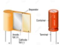
Placez le [condensateur](#) dans la carte où il est étiqueté C1. Assurez-vous que l'appareil est dans le bon sens. Le condensateur porte un signe « - » marqué dessus, qui doit correspondre au même signe sur le PCB. **L'utilisation d'un condensateur électrolytique à l'envers pourrait entraîner sa destruction.**
