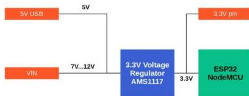
Sur l'image, vous voyez que la connexion USB 5V et la broche VIN sont connectées à un régulateur de tension 3,3V, qui transforme la tension d'entrée entre 5V et 12V en une tension de sortie
