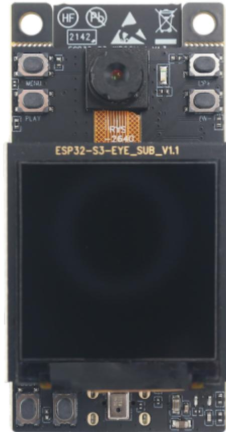
La carte ESP32-S3-EYE se compose de deux parties : la carte principale (ESP32-S3-EYE-MB) qui intègre le module ESP32-S3-WROOM-1, la caméra, l'emplacement pour carte SD, le microphone numérique, le port USB et la fonction boutons; et la sous-carte (ESP32-S3-EYE-SUB) qui contient un écran LCD. La carte principale et la sous-carte sont connectées via des embases à broches.
