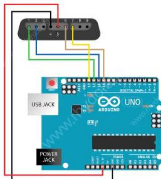
Nous avons interfacé la manette PS2 avec un Arduino. À chaque pression sur un bouton, l'Arduino reçoit le signal PS2 et l'affiche sur l'interface Serie. Nous avons suivi le protocole standard PS2 pour réaliser l'algorithme de communication, identique au protocole SPI. Notre programme sur l'arduino détecte et lit uniquement les pressions sur les boutons, les valeurs de pression ne sont pas lues. Les valeurs d'état du stick analogique sont affichées en continu sur l'interface serie.
