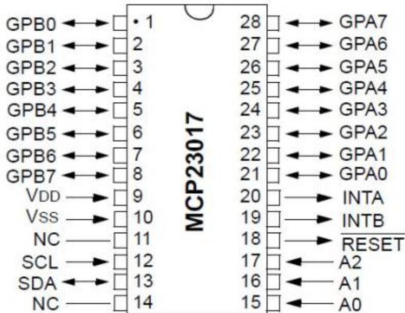
[MCP23017 16 entrées/sorties sur un arduino](#)
