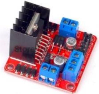
Carte de contrôle des moteurs (L298N – « double pont en H ») :
