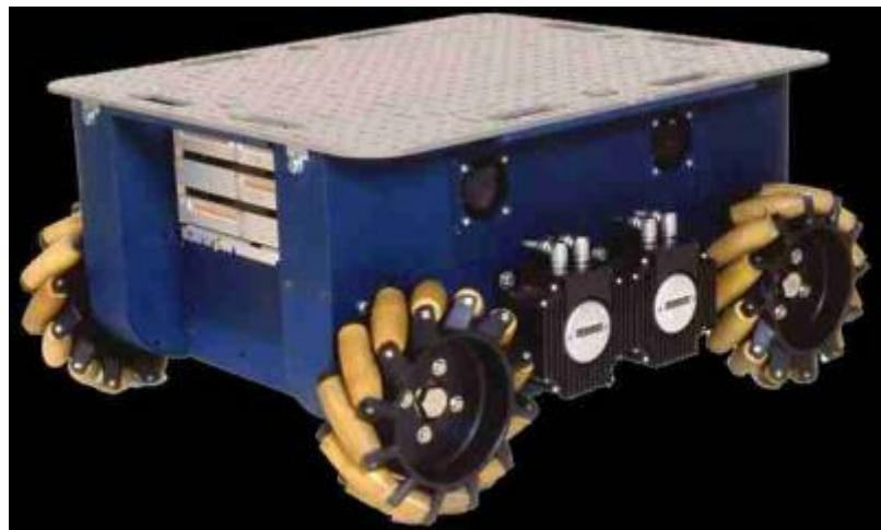
Les robots à roues Mecanum pour se déplacer avec des exigences de vitesse minimales. Par exemple:
