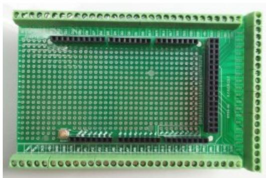
[Shield raccordement à vis arduino Méga](#)
