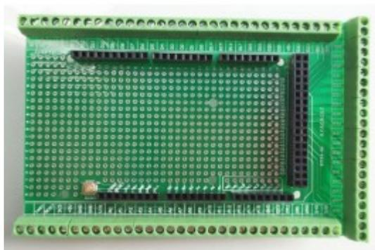
[Shield raccordement à vis arduino Méga](#)
