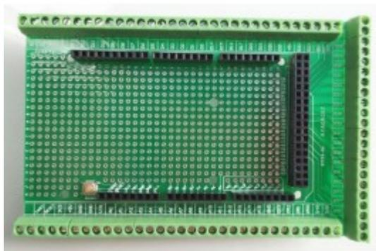
[Shield raccordement à vis arduino Méga](#)
