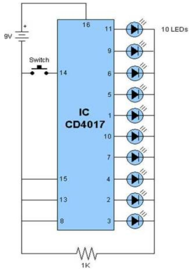
**Avec un arduino en raccordant une broche de sortie ( exemple 8) sur l'entree Horloge du cd4017**
