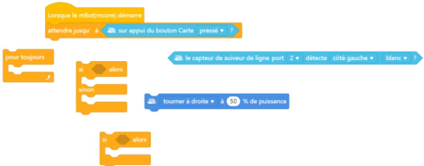
**Détecteur de ligne noire** Le robot dispose de deux phototransistors qui émettent chacun une lumière. Si le robot passe sur une surface claire (idéalement blanche) la lumière réfléchiée et le phototransistor associé envoie un signal électrique. Si le robot passe sur une surface noire, la lumière n'est pas réfléchiée et aucun signal n'est envoyé. Chaque phototransistor peut donc piloter l'un des moteurs du robot.
