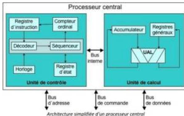
**Le microprocesseur** est le centre de commande et le calculateur électronique de l'ordinateur.
