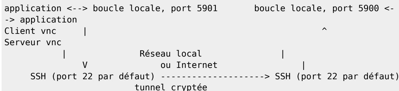
On peut créer un alias pour le tunnel, à l'aide d'un fichier de configuration "~/.ssh/config" (à créer). Ce fichier aura par exemple le contenu suivant dans notre exemple :
