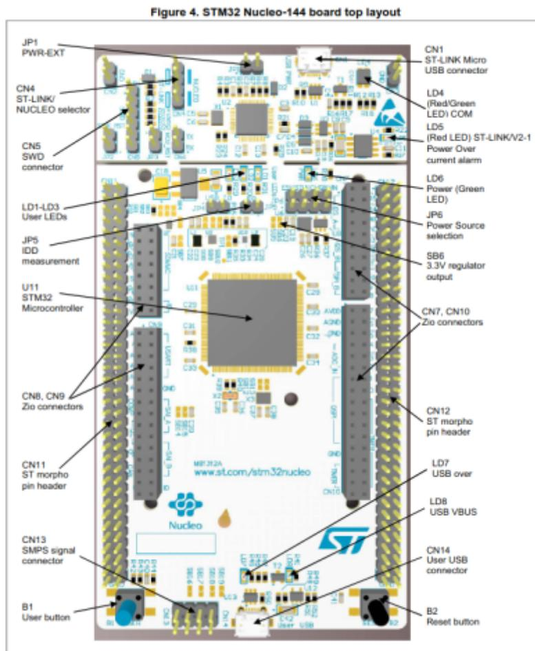
1. -. Vérifiez la position du cavalier sur la carte : JP1 (PWR-EXT) OFF (voir Section 5.5.1 : Entrée d'alimentation de ST-LINK/V2-1 USB connecteur pour plus de détails) JP6 (source d'alimentation) côté ST-LINK (pour plus de détails, voir le tableau 7 : cavalier lié à l'alimentation) JP5 (IDD) ON (pour plus de détails, voir Section 5.8 : JP5 (IDD)) CN4 ON sélectionné (pour plus de détails, voir Tableau 4 : états CN4 des cavaliers).
