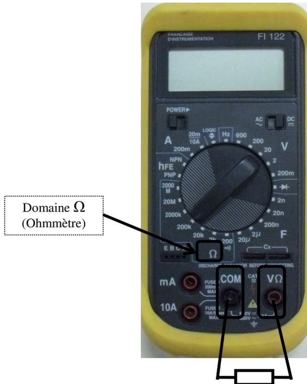
• Pour mesurer la valeur d'un résistor on utilise la fonction ohmmètre du multimètre : domaine  $\Omega$ .
