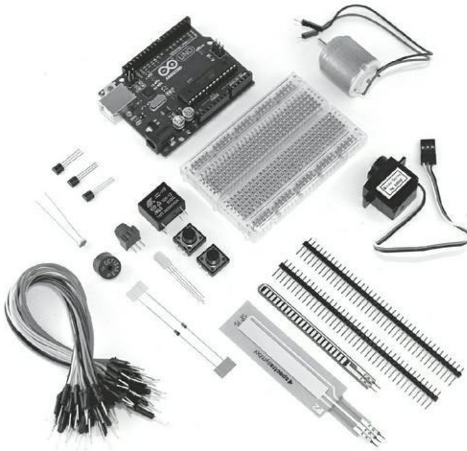
FIGURE 2-5 Le kit SparkFun Inventor comprend un bon éventail de composants, dont des potentiomètres linéaires et sensibles à la flexion.
