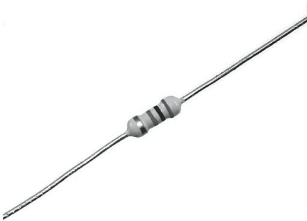
FIGURE 6-10 Les anneaux de couleur d'une résistance.
