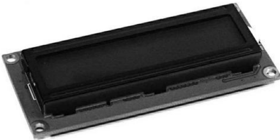
Figure 9.61 : Afficheur deux lignes de 16 caractères basé sur HD44780 ou ST7066.
