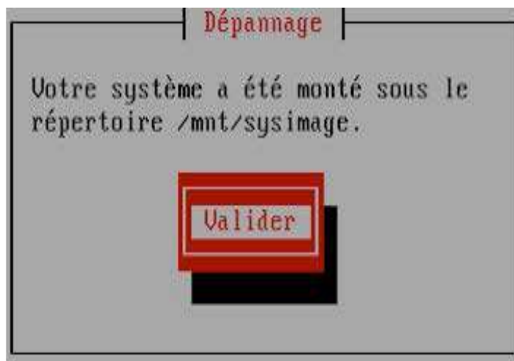
Figure 4. Montage du système : le mode dépannage cherche l'installation Linux et la monte sous le répertoire /mnt/sysimage
