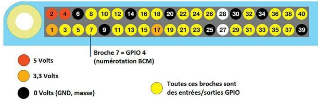
Figure 16.3 : Schéma du connecteur GPIO.
