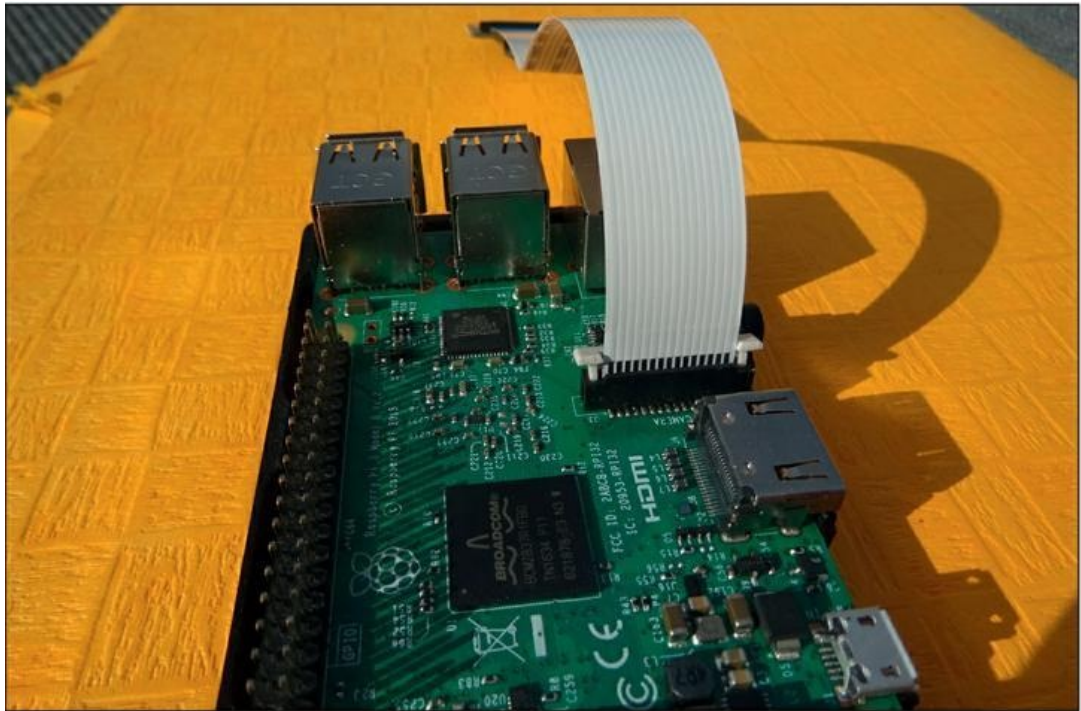
Figure 15.2 : Insertion du câble.
