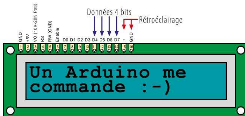
◀ Figure 13-5 Branchements du module d'affichage
