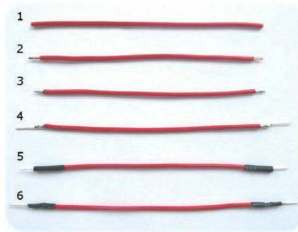
Figure 7-15 ► Les différentes phases de fabrication d'un cavalier flexible
