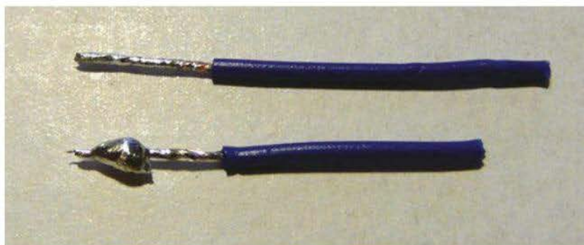
Figure 7-11 ► Une bonne et une mauvaise soudures
