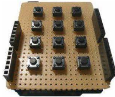
Figure 12-7 ► Réalisation du clavier numérique avec son propre shield
