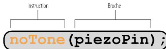
Figure 16-2 ► La fonction noTone rend le piézo muet.
