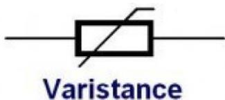
La varistance est un composant de protection qui protège des surtensions. Isolante à faible tension (très forte résistance), elle devient conductrice (très faible résistance) quand la tension dépasse sa valeur nominale (typiquement 320 V Ac pour un appareil branché sur le 220 V). Au-delà de sa tension nominale, cette valeur de résistance tend très rapidement (en moins d'une microseconde) vers une valeur très faible (phénomène d'avalanche).
