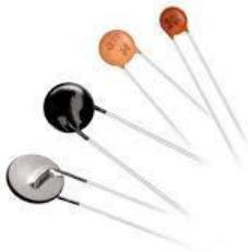
La thermistance est une résistance électrique dont la valeur varie en fonction de la température (CTN Coefficient en Température Négatif, la valeur baisse avec la  $t^{\circ}$  - CTP Coefficient en Température Positif, la valeur augmente avec la  $t^{\circ}$ ). Généralement, à température ambiante ce composant présente une valeur de résistance électrique qui peut varier lorsqu'on le pince entre ses doigts. La thermistance comprend un corps et deux bornes d'extrémité B1 et B2.
