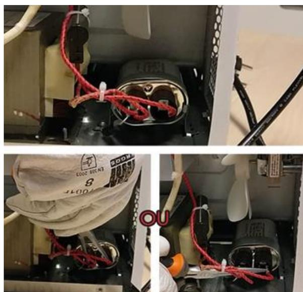
Le connecteur se situe en dessous du magnétron. Il s'agit d'un connecteur à laquelle les fils électriques sont raccordés. Pour l'enlever, utilisez une pince non coupante et ôtez la pièce en effectuant de légers mouvements horizontaux, tout en tirant de bas en haut.
