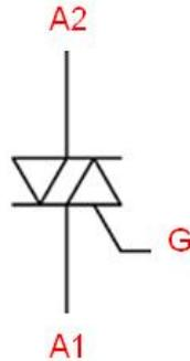
Un Triac est un interrupteur bidirectionnel, il se comporte comme deux thyristors tête bêche. Il laisse passer le courant dans les deux sens. On peut vérifier qu'un triac est fonctionnel avec un multimètre.
