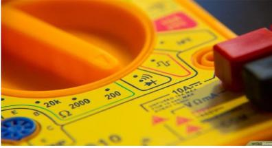
Le test d'un transistor bipolaire revient à tester deux diodes.
