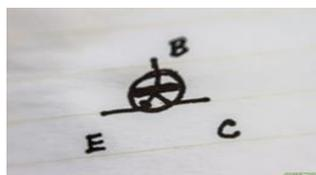
**Un transistor correspond basiquement à deux diodes qui partagent une électrode.** Cette borne mise en commun est appelée la « base » tandis que les deux autres électrodes du transistor sont appelées l'« émetteur » et le « collecteur ». Le collecteur accepte un courant d'entrée en provenance du
