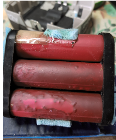
Ouverture d'une batterie d'outillage sans fil, les éléments sont hors service.
