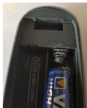
Contact de pile oxydé
