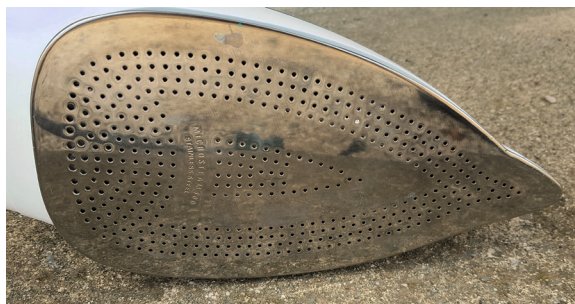
Perforations de la semelle pouvant être obstruées
