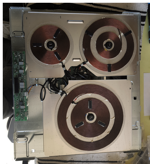
Carte des commandes sensibles (à gauche) et bobines constituant les foyers d'une table à induction
