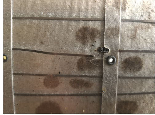
Coupure d'une résistance sur une feuille de mica
