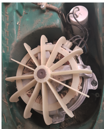
Moteur de tondeuse à gazon avec condensateur de démarrage
