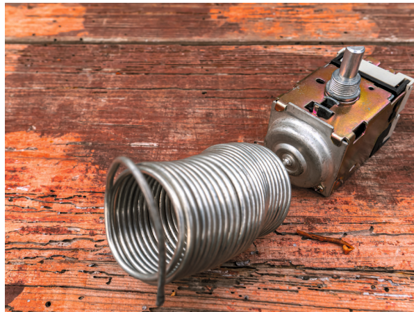
Thermostat électromécanique avec bulbe
