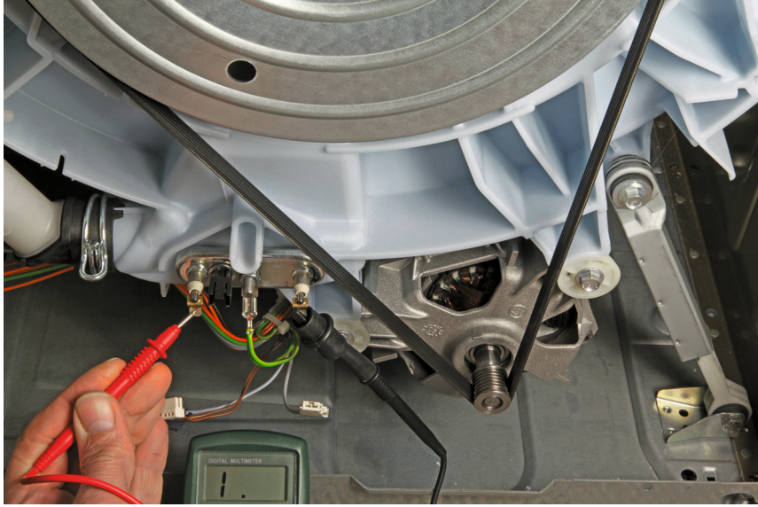
Courroie de lave-linge et vérification de la résistance de chauffage déconnectée
