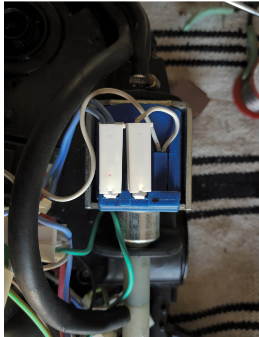
Pompe d'une centrale vapeur comportant un fusible thermique intégré à droite des connexions
