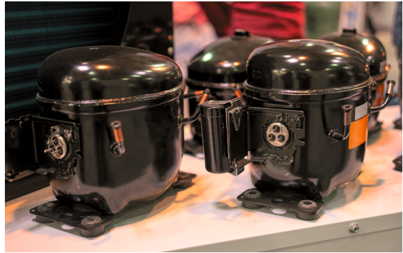
Moteur de compresseur de réfrigérateur, le relais s'emboîte sur les trois broches de connexion.
