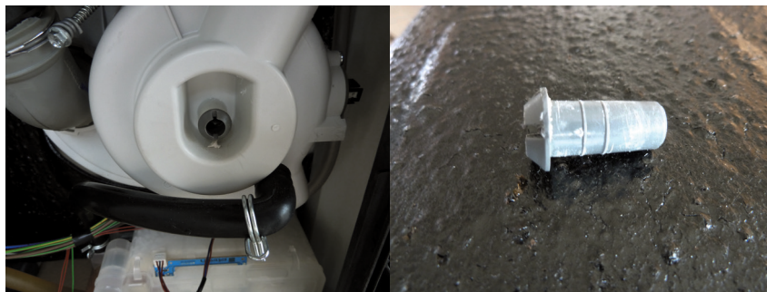
Clapet antiretour situé au fond de la cuve de brassage
