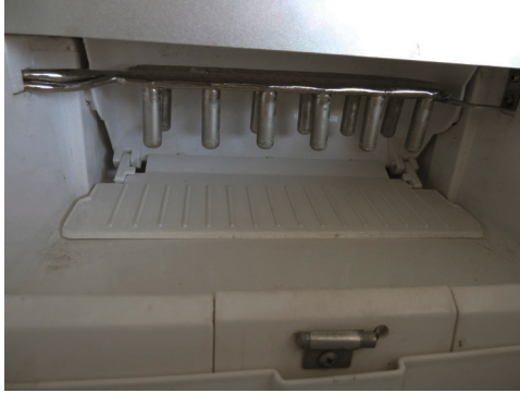
Cuve avec doigts de surgélation, bac mobile et sonde du bac à glaçons
