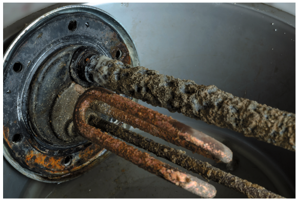
Résistance blindée en mauvais état
