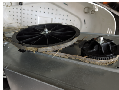
Mécanisme à courroies détériorées
