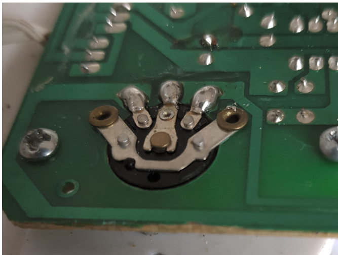
Bornes de connexion du potentiomètre de réglage du temps de chauffe
