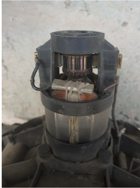
Moteur universel de motobineuse avec protection thermique fixée sur l'enroulement du stator
