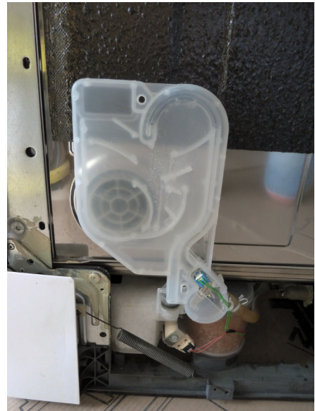
Circuit d'admission de l'eau avec son capteur de débit et adoucisseur en dessous
