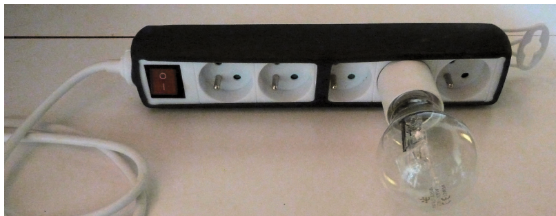
Prise protégée par une lampe d'éclairage placée en série
