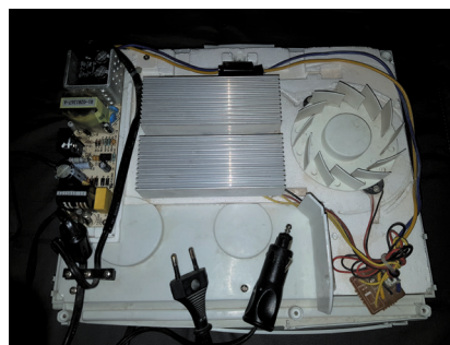
Constitution d'une glacière électrique à double alimentation
