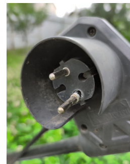
Prise de motobineuse sans terre et intégrée au manche de l'appareil
