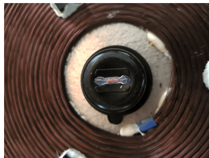
Capteur de température au centre d'un foyer à induction
