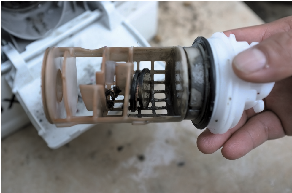
Trappe d'accès à la pompe de vidange et filtre
