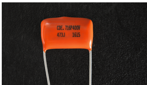
Identification d'un condensateur de 47 nanofarads 400 V
