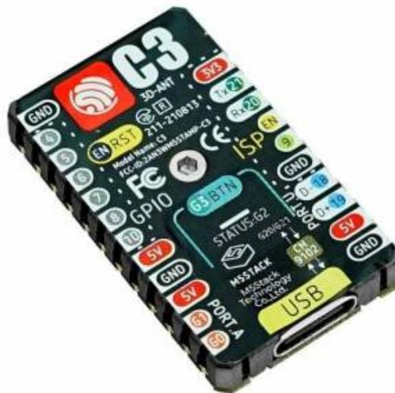
L'**ESP32-C3** est un SoC à microcontrôleur Wi-Fi et Bluetooth 5 (LE) monocœur, basé sur l'architecture **RISC-V open source**. Il trouve le bon équilibre entre puissance, capacités d'E/S et sécurité, offrant ainsi la solution optimale et rentable pour les appareils connectés. La disponibilité de la connectivité Wi-Fi et Bluetooth 5 (LE) facilite non seulement la configuration de l'appareil, mais facilite également une variété de cas d'utilisation basés sur la double connectivité.
