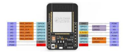
Le raccordement des broches TX et RX , doit être vérifié , le schéma indique un branchement croisé entre l'ESP-Cam et USB-Serie ce qui veut dire : TX ESP (GPIO1) sur RX série et RX ESP (GPIO3) sur TX Série
