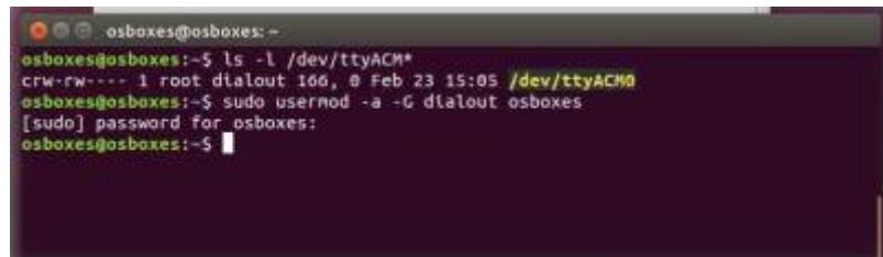
C'est la procédure pour accéder au port série à partir du logiciel Arduino (IDE) si vous obtenez une erreur
