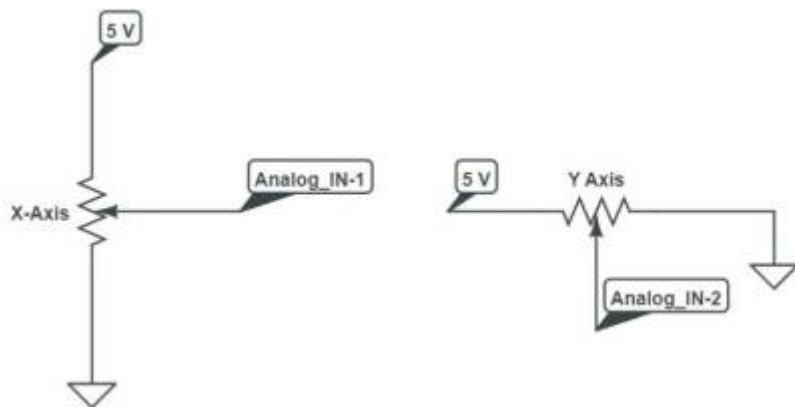
Les potentiomètres reposent toujours en position centrale. Si le potentiomètre est alimenté en 5 V, la valeur analogique mesurée au centre du potentiomètre sera de 2,5 V.
