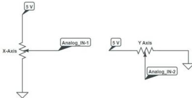
Les potentiomètres reposent toujours en position centrale. Si le potentiomètre est alimenté en 5 V, la valeur analogique mesurée au centre du potentiomètre sera de 2,5 V.
