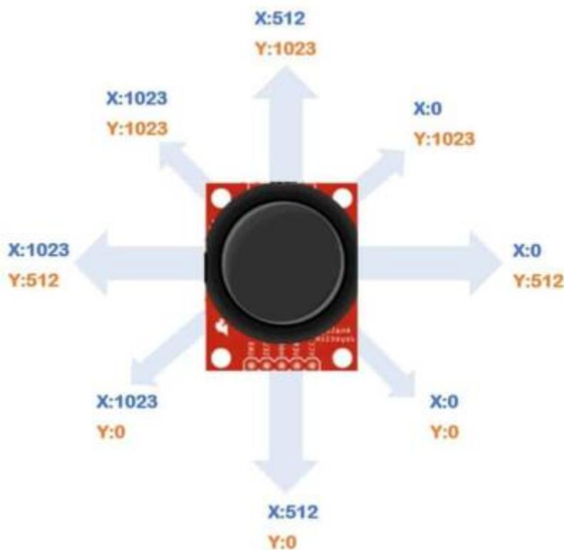
Les deux potentiomètres tournent automatiquement au ralenti en position centrale. Cela signifie que la valeur lue sera la moitié de la résolution maximale de l'ADC.
