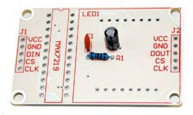
• Souder la capacite C2 , laisser un peu de marge pour pouvoir piler le condensateur sur la plaque
