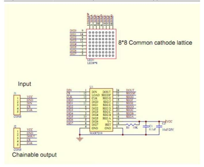
Schéma des connections de la matrice de LEDS 8×8
