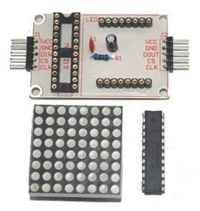
• Vérifier la position de C2 et installez le C.I. MAX7219 et la matrice de LEDS sur leurs connecteurs.
