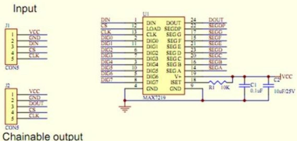
Schéma des connections de la matrice de LEDS 8x8
