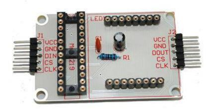
• Souder le connecteur du circuits intégré MAX7219
