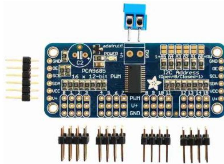
Permet de contrôler jusqu'à 16 servo-moteurs (ou LEDs) en PWM.
