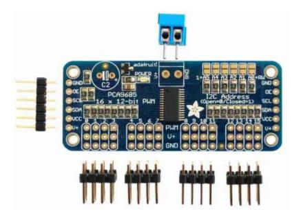
Permet de contrôler jusqu'à 16 servo-moteurs (ou LEDs) en PWM.
