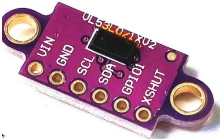
Le télémètre laser **VL53L1X** Arduino est un capteur permettant de mesurer la distance d'un obstacle **jusqu'à 4 mètres** de distance avec une longueur d'onde de 940 nm (inoffensif pour les yeux). Les modules télémétriques **VL53L0X**, **moins chers**, ont **une portée de seulement 2 mètres**.
