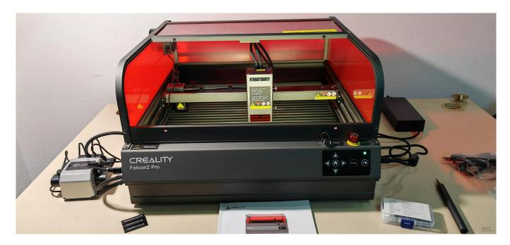
Le Creality Falcon2 Pro est un graveur laser fermé dans un caisson pour que l'opérateur n'ait pas à porter de lunettes. Il existe avec différentes puissances de laser : 1,6W, 22W, 40W et 60W. Il s'agit de l'évolution plus sécurisée du Falcon2, graveur / découpeur ouvert.
