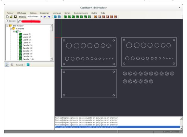
Vous pouvez aussi vérifier les dimensions de votre schéma en utilisant la souris tout en se déplaçcant sur le modèle (en haut à droite, en bas à gauche, en bas à droite), vérifier les coordonnées X et Y en bas à droite (voir capture d'écran):
