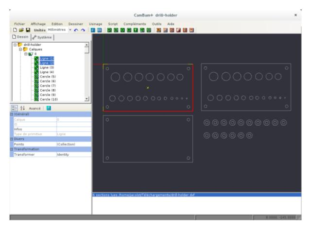
Pour éviter tout problème pour générer le G-code, il est nécessaire de joindre les segments du schéma (ou des parties du schémas), por joindre les segments:
