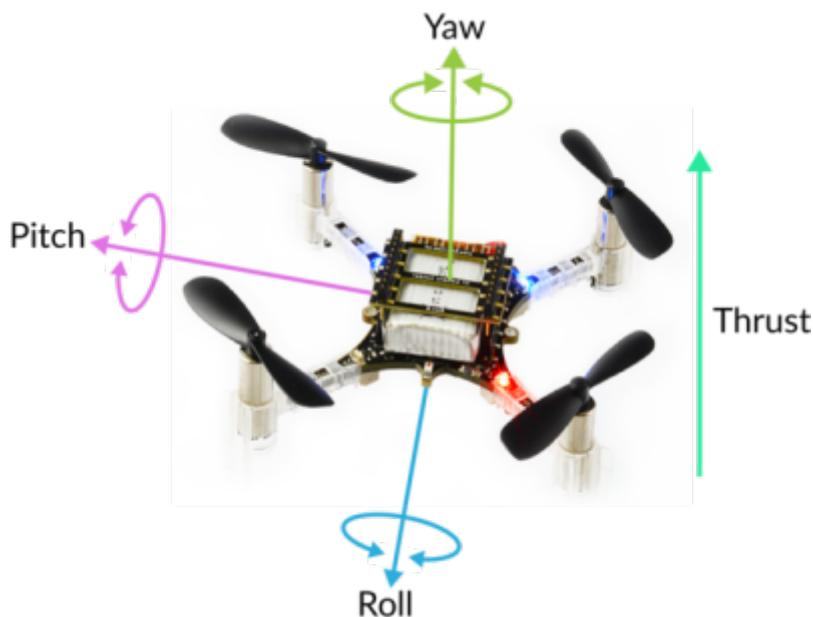
**Roll** (Rouleau) - est la rotation autour d'un axe horizontal qui traverse le quadcopter d'arrière en avant. Cela roule littéralement le Drone et le déplace à gauche ou à droite.
