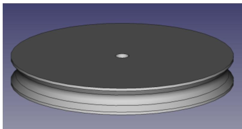
En faisant varier les variables dans la feuille de calcul, le modèle 3D de poulie obtenu est mis à jour automatiquement.
