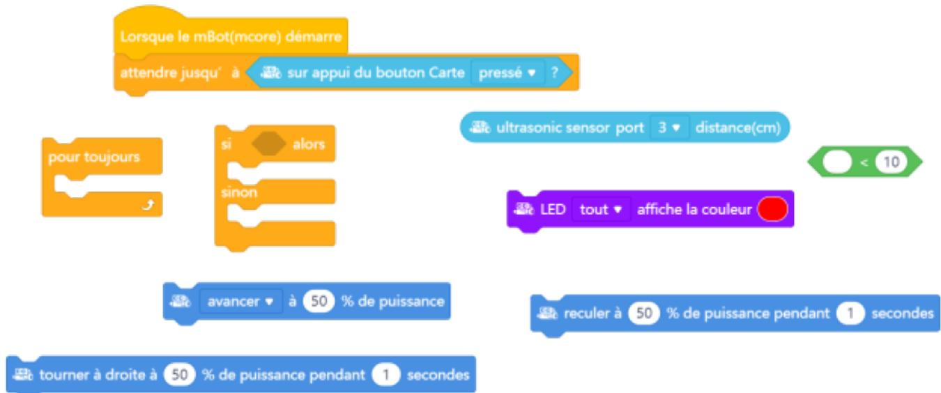
*Si la distance détectée est supérieure à 10 cm, le robot avance, sinon il s'arrête*
