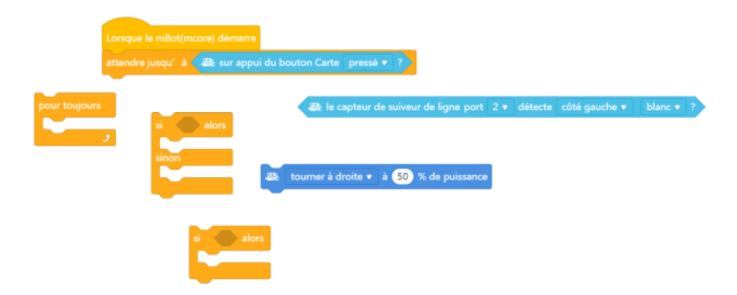
**Détecteur de ligne noire** Le robot dispose de deux phototransitors qui émettent chacun une lumière. Si le robot passe sur une surface claire (idéalement blanche) la lumière réfléchie et le phototransitor associé envoie un signal électrique. Si le robot passe sur une surface noire, la lumière n'est pas réfléchie et aucun signal n'est envoyé. Chaque phototransitor peut donc piloter l'un des moteurs du robot.
