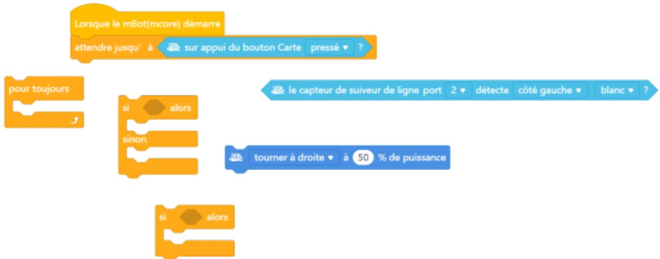
**Détecteur de ligne noire** Le robot dispose de deux phototransistors qui émettent chacun une lumière. Si le robot passe sur une surface claire (idéalement blanche) la lumière réfléchi et le phototransistor associé envoie un signal électrique. Si le robot passe sur une surface noire, la lumière n'est pas réfléchi et aucun signal n'est envoyé. Chaque phototransistor peut donc piloter l'un des moteurs du robot.
