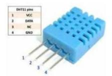
un **DHT11** fournira en **I2C** la température et l'humidité. il sera placé en partie **basse** de la ruche.
