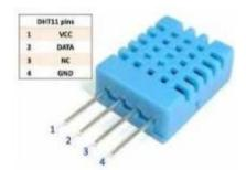
un **DHT11** fournira en **I2C** la température et l'humidité. il sera placé en partie **basse** de la ruche.
