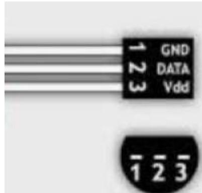
un "trois pattes" digital en connexion bus **I2C** connecté sur le GPIO 4 de l'**ESP32**. Il sera placé en partie haute de la ruche
