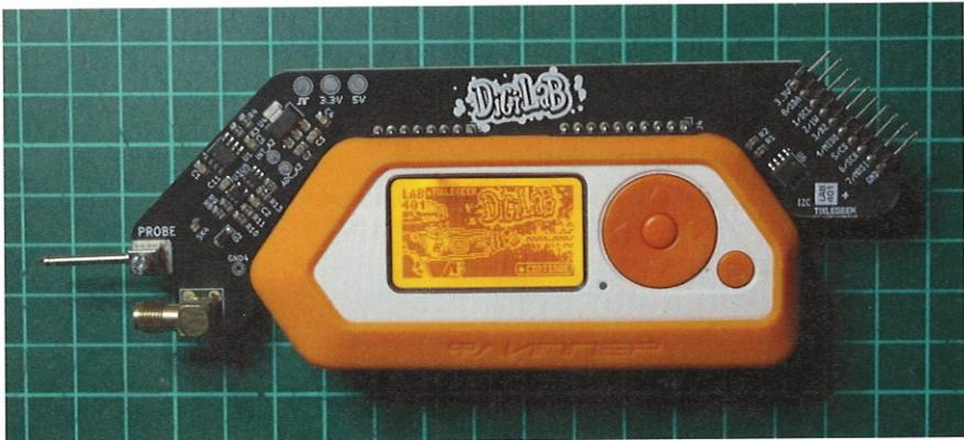
Le DigiLab se connecte et devient une partie intégrante du Flipper Zero en adoptant le même profil. Ceci permet d'utiliser l'ensemble d'un seul bloc comme un testeur, même sans les sondes (à condition de connecter la masse à la cible, bien sûr).
