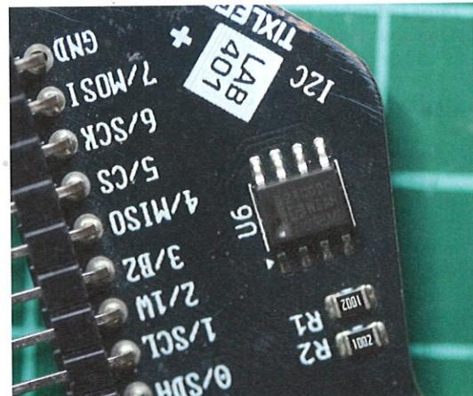
Le DigiLab intègre par défaut une EEPROM i2c de 256 octets 24C02. Celle-ci pourra être utilisée pour les tests et, pourquoi pas, servir à une évolution future de l'application...
