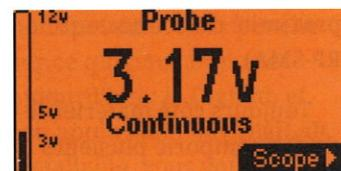
Cette fonction est accessible depuis le menu, mais également en appuyant sur « droite » du *pad* lorsqu'on est sur l'oscilloscope. Et inversement, en mode « probe », la même action renvoie au « scope », montrant clairement que les deux fonctionnalités ont été pensées pour fonctionner de concert.
