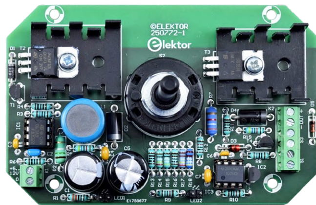
Figure 4. PCB assemblé vu du dessus ; les CI sont dans leurs supports.
