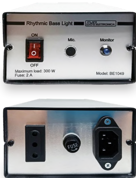
Figure 3. Panneaux avant et arrière du contrôleur d'effet lumineux au rythme des basses.
