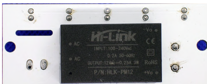
Figure 3. Le module d'alimentation, monté à l'arrière et soudé côté composants du PCB.
