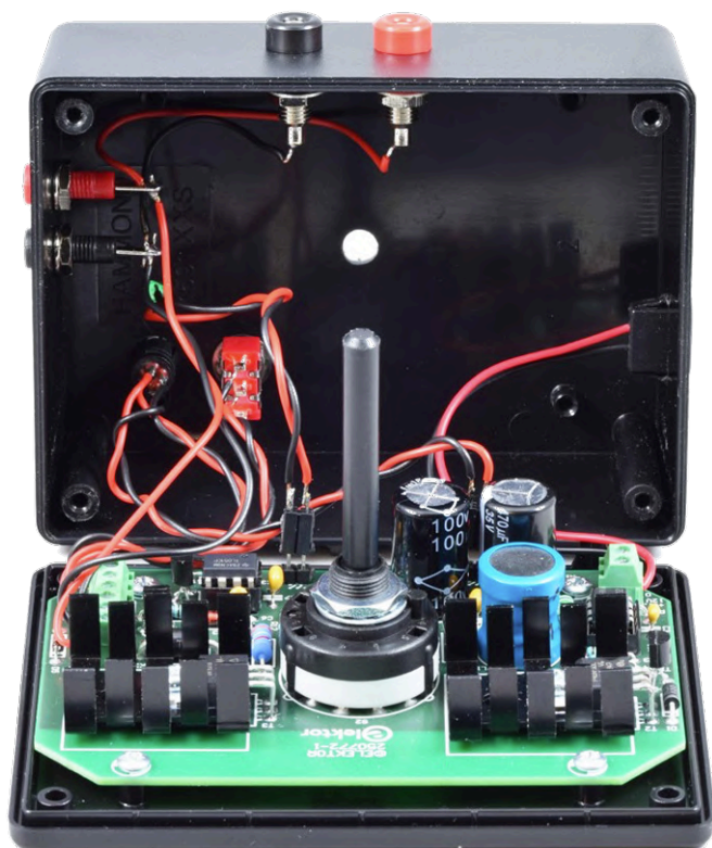
Figure 6. Vue interne du câblage : PCB, commandes et connecteurs.
