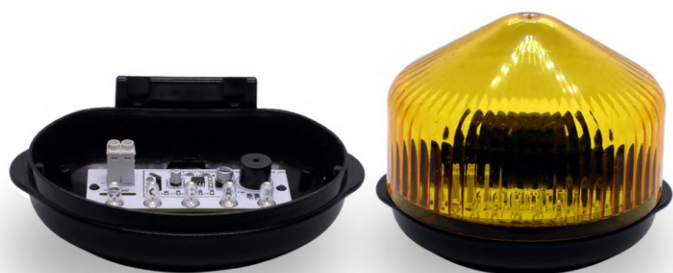
Figure 4. La carte de la lampe clignotante installée dans un boîtier plastique prêt à l'emploi après la mise à niveau.
