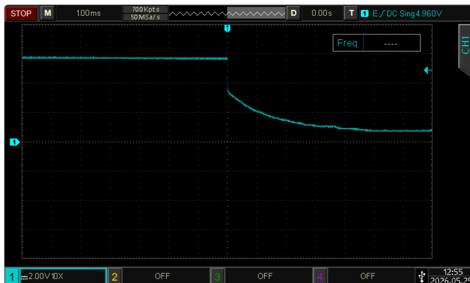
Figure 4. capture monocoup de l'échelon de charge à 2 V/div, 1 ms/div, couplage CC. Le front abrupt marque l'amorçage du MOSFET ; la courbe descendante traduit la décharge du condensateur de sortie avant que la boucle CC stabilise la sortie.
