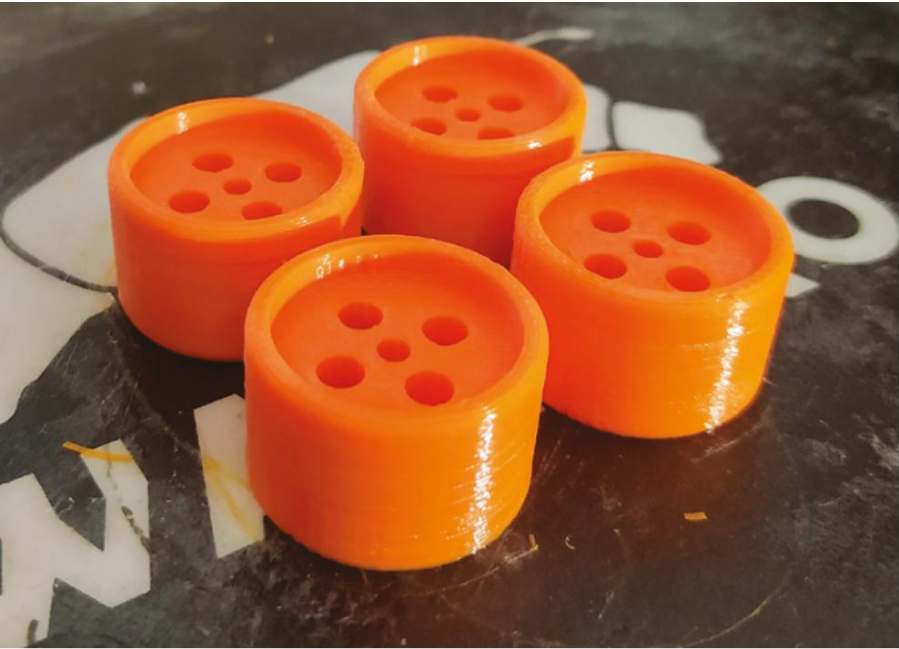
Figure 11 Notre conception de roues, exportée et impression 3D
