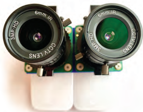
▲ Le montage du tutoriel Assembler une caméra 3D.
