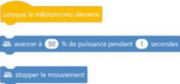
La vitesse est fixée par le pourcentage de puissance. Il est conseillé d'éviter des puissances trop basses lorsque les piles ou batteries commencent à être déchargées.
